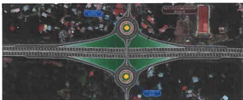
Ilustración 3-10 Propuesta de Mejoramiento de Intercambiador - Bique.
